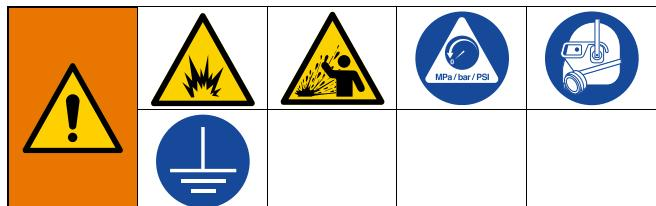
为了避免发生火灾和爆炸，请务必保持地面设备和废物容器接地。为了避免静电火花和流体飞溅伤害，请保持用尽可能低的压力冲洗。
