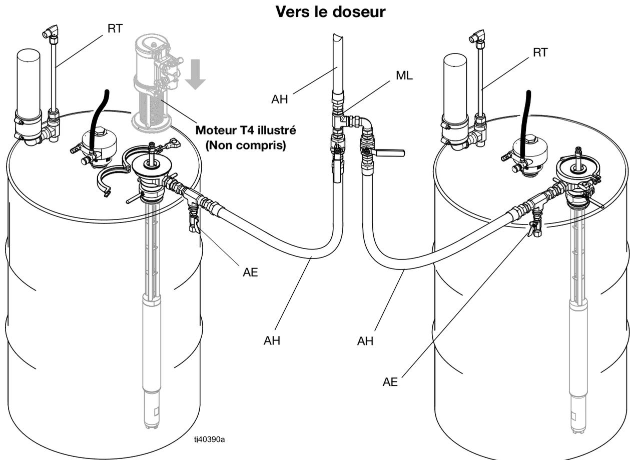
**Fig. 1: Installation type de bas de pompe multiples**
