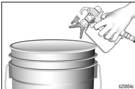
**Siempre conecte a tierra un cubo metálico:** conecte un cable de tierra al cubo. Sujete un extremo al cubo y el otro a una toma de tierra fiable, como una tubería de agua.
