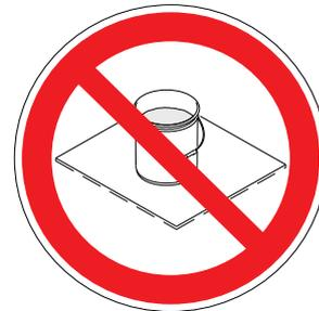
**Les seaux métalliques doivent toujours être mis à la terre :** Raccorder un fil de terre au seau. Fixez une extrémité au seau et l'autre extrémité à une prise de terre telle qu'une canalisation d'eau.
