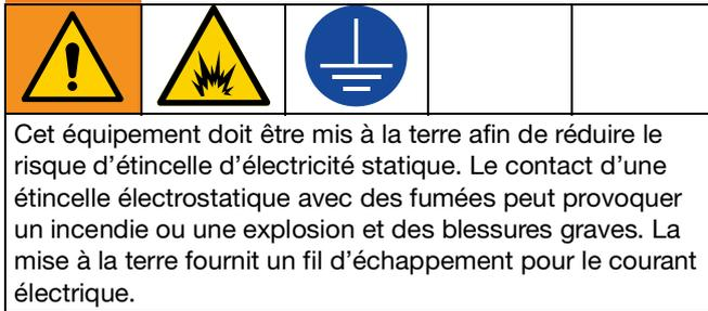
Positionnez le traceur de façon à ce que les roues soient bien en contact avec une surface véritablement mise à la terre, pas sur la chaussée ni à l'arrière d'une remorque ou d'un camion.
