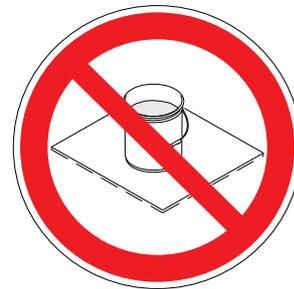
**Collegare sempre a terra un secchio metallico:** Collegare un filo di messa a terra al secchio. Bloccare un'estremità al secchio e l'altra a una messa a terra efficace, come un tubo dell'acqua.
