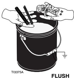
5. Collegare il filo di messa a terra a una messa a terra efficace o collegare l'unità a una presa dotata di messa a terra.
