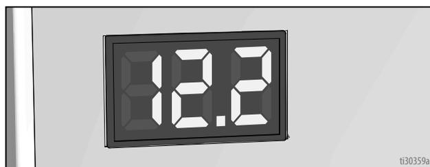
5. Аккумулятор зарядится до 14,6–14,8 В, а затем при полной зарядке напряжение опустится примерно до 13,6 В.
