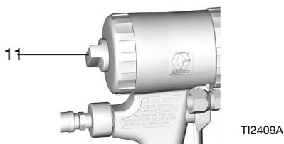
2. Empuje el adaptador de la boquilla de pulverización (3) hasta que quede a nivel con la parte delantera de la pistola.
