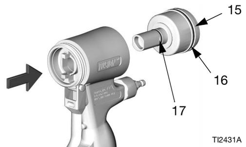
6. Lubrificare liberamente gli O-ring del pistone. Reinstallare il pistone. L'albero è polarizzato per garantire un montaggio corretto. Premere saldamente per posizionare il pistone.
