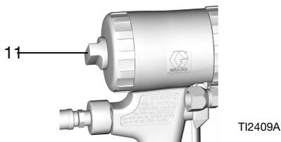
2. Spingere l'adattatore dell'ugello di spruzzatura (3) fino a portarlo a filo con la parte anteriore della pistola. In tal modo ci si assicura che la camera di miscelazione è spinta completamente indietro.
