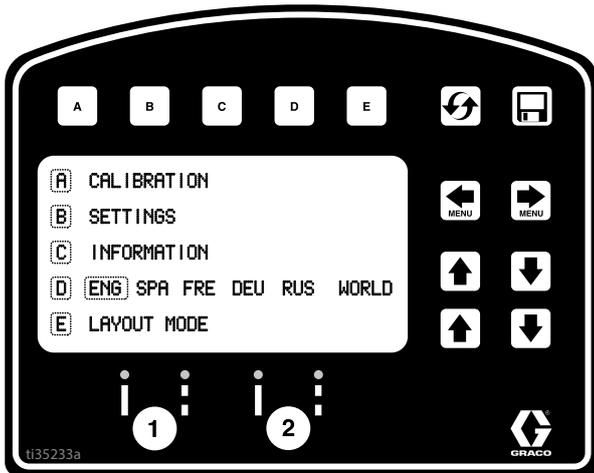
4. Premere **A** per la calibrazione. Impostare DIST CORSA su un valore pari o superiore a 7,6 m (25 piedi). Distanze superiori assicurano una migliore precisione, in base alle condizioni.
