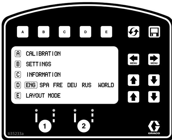
4. 按下 **A** 进行校准。将行进距离 (TRAVEL DIST) 设定为 25 英尺 (7.6 米) 或更长。根据条件, 距离越长能确保精度越高。
