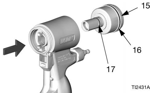
6. 给活塞 O 形圈涂抹适量的润滑脂。重新装上活塞。为便于正确装配，轴杆上带有键槽。用力推送使活塞就位。
