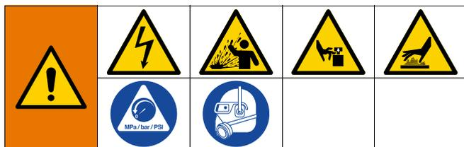
本设备在手动释放压力之前一直处于加压状态。为了防止高压流体（例如飞溅的液体和活动部件）造成严重伤害，请在停止操作后，进行清洁、检查或维修设备之前参考泄压步骤执行泄压。
