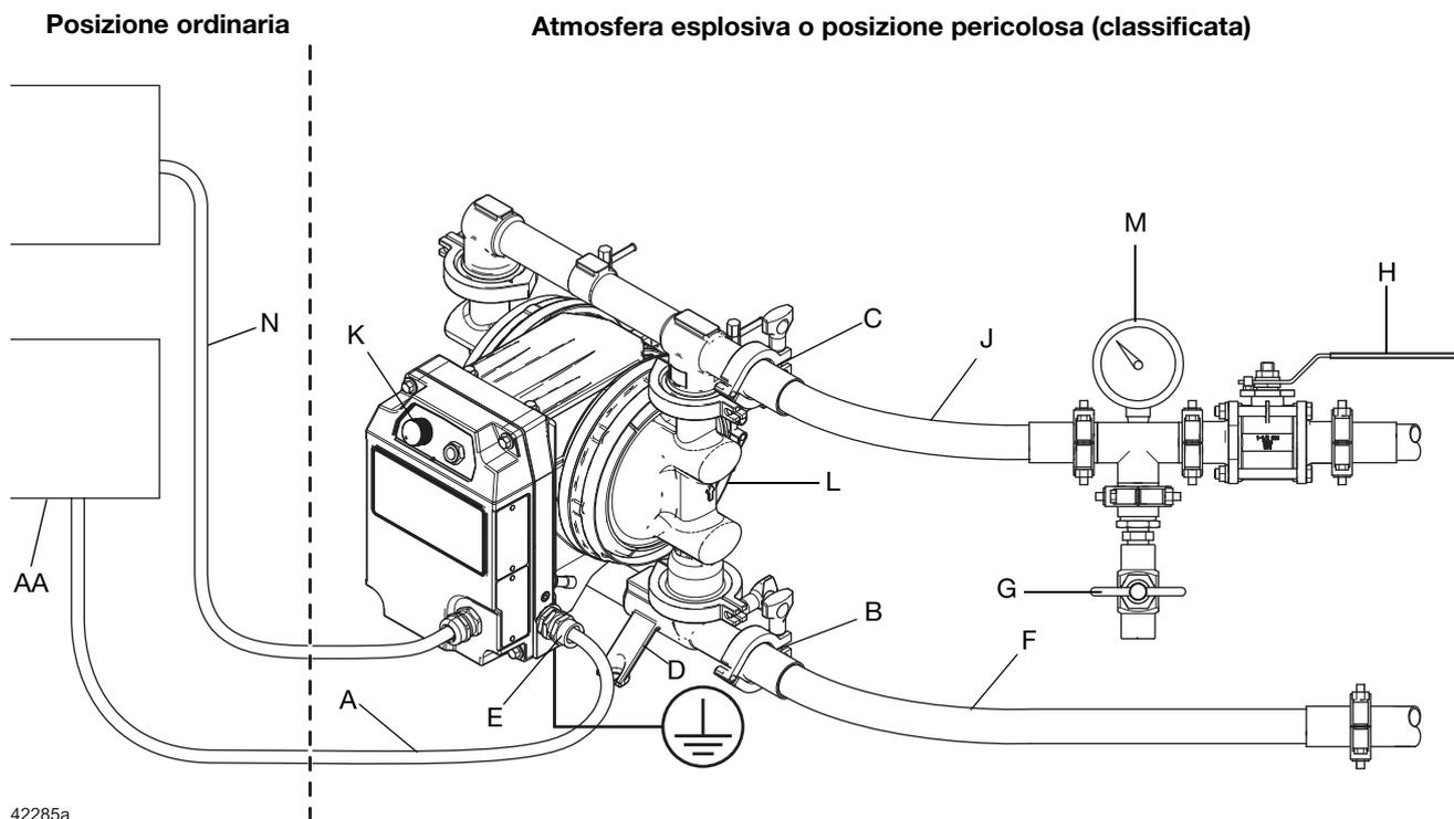
FIG. 4: Installazione tipica per modelli in atmosfere esplosive o luoghi pericolosi (classificati) (cablaggio fisso per connessione permanente) (modello h30 (QHC) mostrato)
