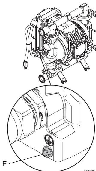
FIG. 7: Apparecchiatura di fissaggio a terra
