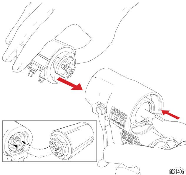
5. Rode o cartucho de fluido FX 1/8 de volta no sentido dos ponteiros do relógio para a posição vertical.
