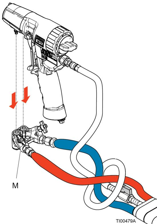
3. Retire o acessório de lubrificação (55) do coletor de lavagem (Z) e instale o acessório do adaptador (56).
