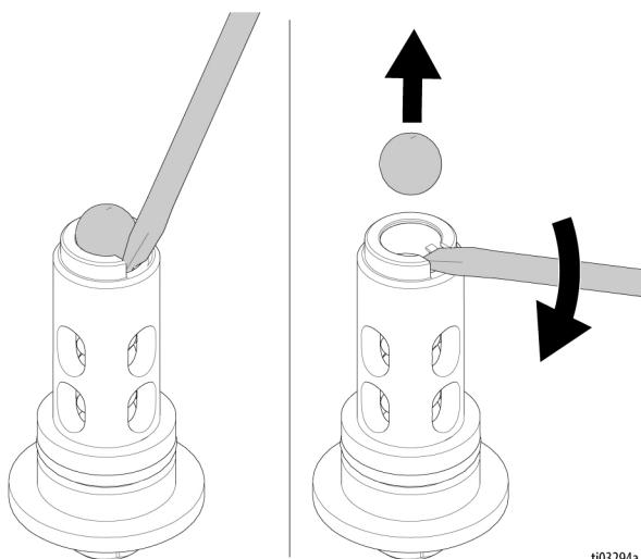
4. Substitua a mola da válvula de retenção.
