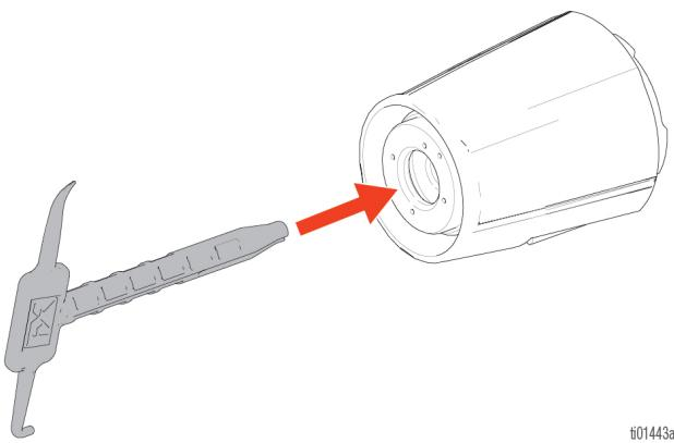
4. Verifique se existem obstruções nas saídas do lado A e do lado B do cartucho de fluido FX (Y) com a ferramenta de verificação de obstruções. O cartucho de fluido FX fica obstruído se a ferramenta de verificação não entrar na saída do lado A ou B.
