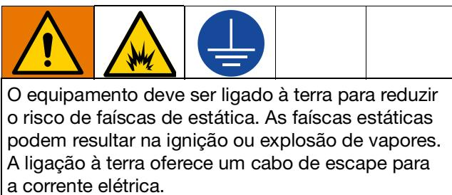
**Pistola de pulverização:** Ligue à terra através da ligação a uma bomba e tubo flexível de líquido devidamente ligados à terra.
