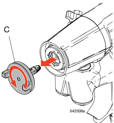
7. Rode o cartucho de fluido FX (Y) no sentido contrário ao dos ponteiros do relógio 1/8 de volta e puxe-o para fora para retirar o cartucho de fluido FX do corpo da pistola (F).
