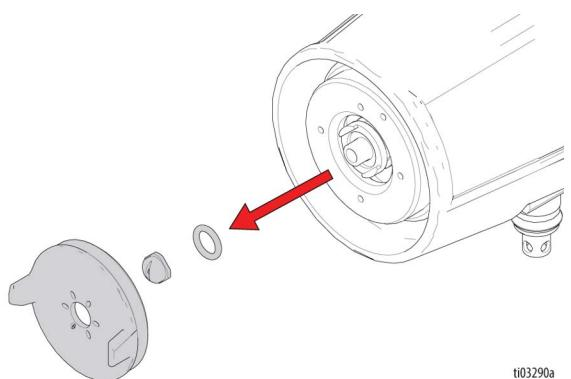
**NOTA:** Se a ponta de pulverização estiver presa, retire-a com uma pequena chave de fendas ou puxe-a com um alicate. A ponta de pulverização plana é rígida para resistir a danos.
