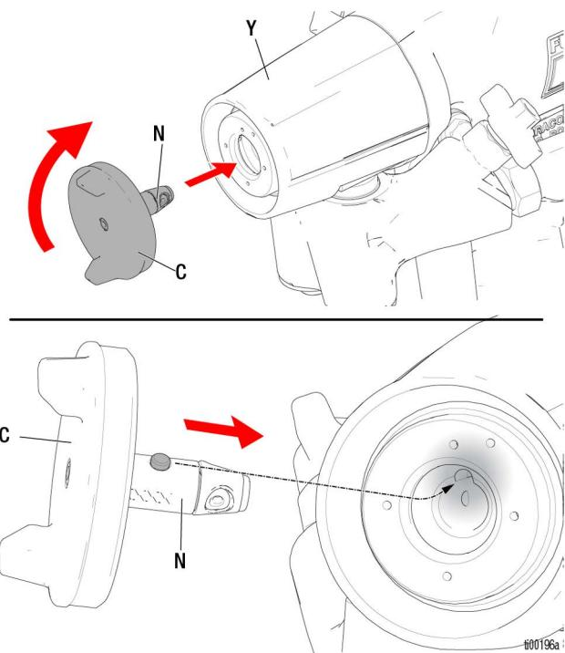
8. Aperte o espalhador com uma chave de porcas para assentar completamente a câmara de mistura.
