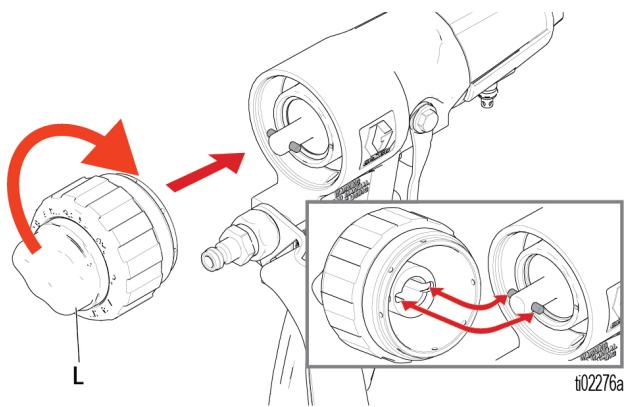
7. Instale o conjunto do espalhador e da câmara de mistura.
