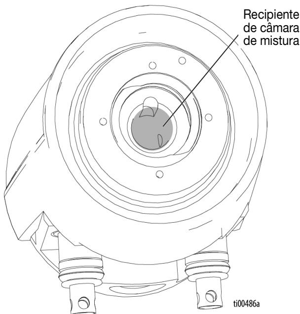
3. Se for detetada uma reação química (espuma ou poliureia) no recipiente da câmara de mistura, limpe o recipiente com a ferramenta de limpeza de cartuchos de fluido FX.
