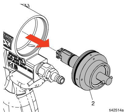
5. Certifique-se de que os o-rings (2k) e (2d) estão instalados no pistão de ar de purga de ar e lubrificados. Instale o pistão de ar de purga de ar. O veio do pistão é dentado para permitir a montagem correta.
