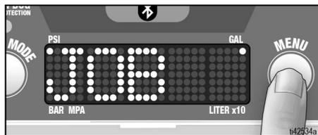
7. Menü-Taste gedrückt halten, um den Wert auf Null zurückzusetzen, oder kurz auf die Taste drücken, um zur Mengenanzeige Gesamt (Gallonen Gesamt [Lifetime Gallons] oder Liter Gesamt [Liters x 10]) zu wechseln.
