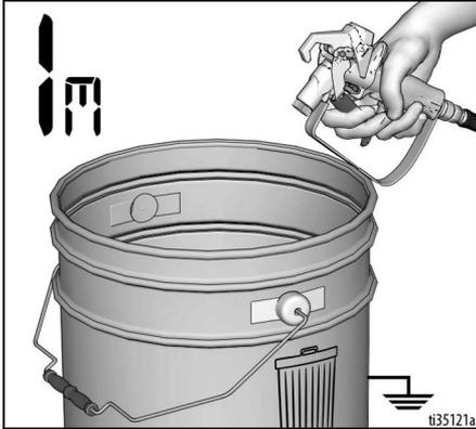
10. Die Pistole in den Farbeimer richten und 20 Sekunden lang den Abzug betätigen. Den Abzug loslassen und Druckaufbau im Spritzgerät zulassen. Die Abzugssperre verriegeln.
