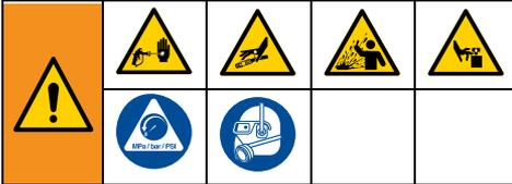
Dieses Gerät bleibt unter Druck, bis der Druck manuell entlastet wird. Zur Vermeidung schwerer Verletzungen durch Material unter Druck – z. B. Eindringen von Material in die Haut, Materialspritzer oder bewegliche Teile sind nach Abschluss des Spritzvorgangs sowie vor Reinigung, Prüfung oder Wartung des Geräts die Schritte zur **Druckentlastung** durchzuführen.
