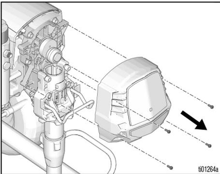
4. Die beiden vorderen Schrauben mit einem 1/4-Zoll-Steckschlüssel entfernen.
