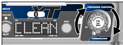
**HINWEIS:** TurboClean wird nur für Reinigungsflüssigkeiten verwendet. Im TurboClean-Modus spritzt das Spritzgerät keine Farbe oder andere Materialien.
