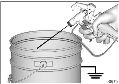
3. Pistole abziehen und Druckregler auf TurboClean stellen.
