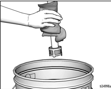
4. Das Saugrohr in die Spülfüssigkeit legen. Wasser für Farbe auf Wasserbasis und Lösungsbenzin für Farbe auf Ölbasis verwenden. Ablassrohr in einen Abfallbehälter geben.
