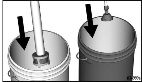
5. Um zu pumpen, das Ansaugventil in die untere Position drehen.
