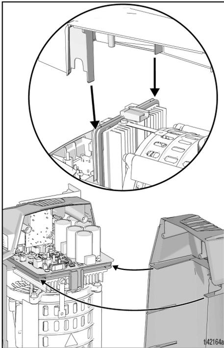
2. Abdeckblech vorsichtig nach unten drücken und die beiden Torx-Schrauben T20 mit einem T20-Werkzeug mit 12-16 in.-lbs festziehen.
