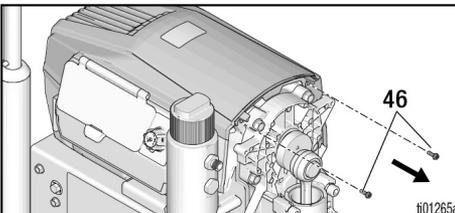
5. Mit einem T20-Werkzeug zwei Torx-T20-Schrauben verwenden. Die obere Abdeckung abnehmen.
