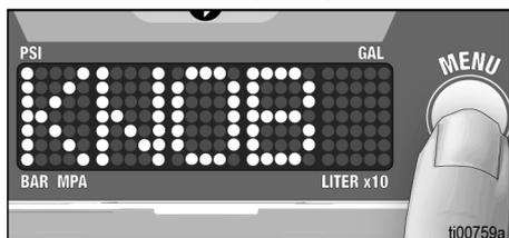
3. Das Potentiometer auf die maximale Spritzposition, kurz vor TurboClean einstellen.
