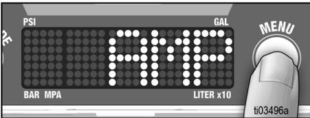
**HINWEIS: AMP SWITCH** wird kurz angezeigt, dann die Amp-Schalter-Einstellung.
