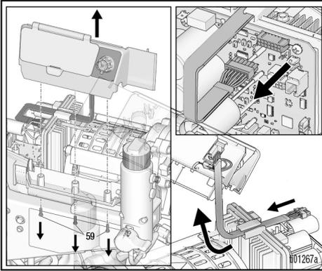
4. Kabelstecker des Potentiometers trennen.
