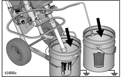
7. Den Druckreglerknopf auf die 10-Uhr-Position drehen. Farbe 15 Sekunden durch das Ablassrohr zirkulieren lassen.
