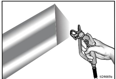
2. Düse mit kleinerer Öffnung verwenden, wenn sich die scharfen Kanten durch die Druckeinstellung nicht beseitigen lassen.
