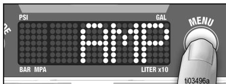
**NOTA:** Viene visualizzato brevemente AMP SWITCH, quindi viene visualizzata l'impostazione del commutatore dell'intensità di corrente.
