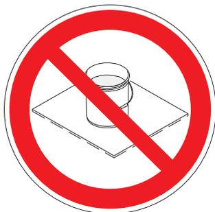
**Collegare sempre a terra un secchio metallico:** collegare un filo di messa a terra al secchio. Fissare un'estremità al secchio e l'altra a una messa a terra efficace, come un tubo di metallo dell'acqua.
