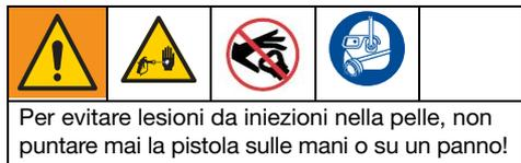
1. Rilasciare il grilletto. Inserire la sicura del grilletto. Ruotare l'ugello di spruzzatura. Disinserire la sicura del grilletto. Attivare la pistola verso una zona di smaltimento per rimuovere le ostruzioni.
