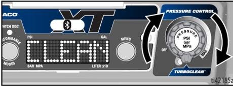
**NOTA:** TurboClean viene utilizzato solo per i fluidi detergenti. Quando è in TurboClean, lo spruzzatore non spruzza vernice o altri materiali.
