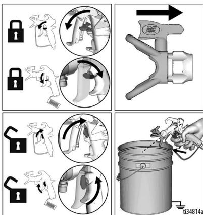
2. Inserire la sicura del grilletto. Riportare l'ugello di spruzzatura nella posizione originale. Disinserire la sicura del grilletto e continuare a spruzzare.
