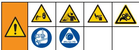
Per evitare lesioni gravi causate dal fluido pressurizzato, ad esempio iniezioni nella pelle, da schizzi di fluido e da parti mobili, seguire la **Procedura di scarico della pressione** quando si termina la spruzzatura e prima di pulire, controllare o sottoporre a manutenzione l'apparecchiatura.
