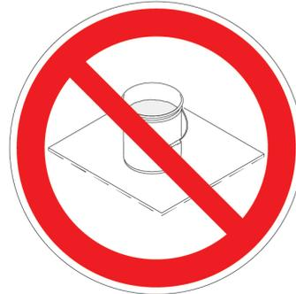
**Metalleimer müssen immer geerdet werden:** Einen Erdungsleiter am Eimer anbringen. Ein Ende am Eimer und das andere Ende an einer wirksamen Erdung wie z. B. einem Wasserrohr anbringen.
