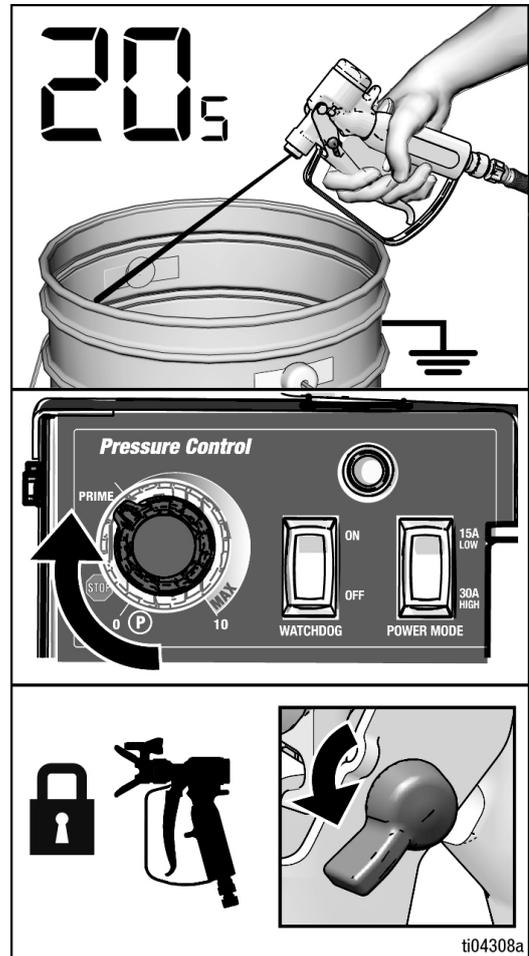
6. Inspeccione las conexiones de la manguera airless en busca de fugas. Si se producen fugas, realice el **Procedimiento de descompresión** y, después, apriete todos los accesorios de conexión y repita el procedimiento de puesta en marcha. Si aún hay fugas, cambie la manguera. Si no hay fugas, continúe con los siguientes pasos.
