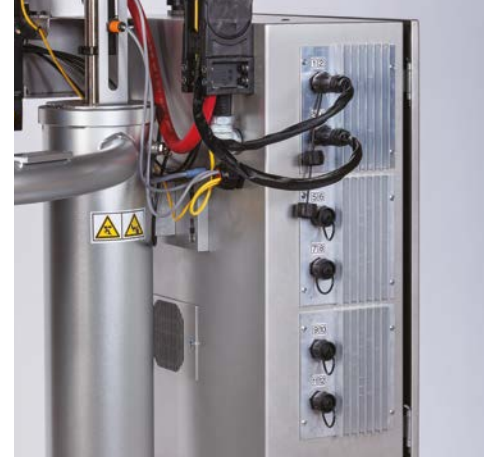
Müşteri tarafından tanımlanmış 12 ısı bölgesi için altı bağlantı noktası
