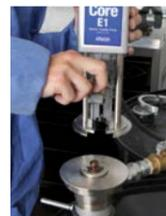
3. Elektromotor verschieben zum Entfernen
