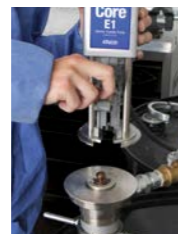
3. Schuif de elektrische motorom te verwijderen
