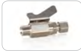
部件号 入口/出口 npt 237538 3/8" 外径的管子 x 3/8" NPT(M)
