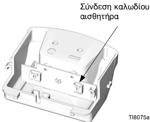
Εικ. 15. Σύνδεση καλωδίου αισθητήρα
