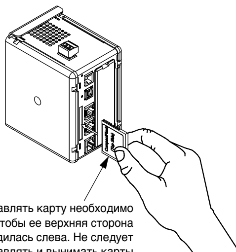
Рис. 12: Установка карты CompactFlash
