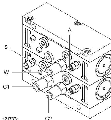
Figure 10 Соединения смены цветов (нециркуляционная система)
