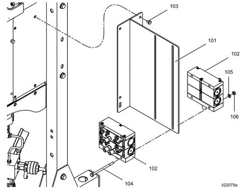
Figure 7 Установка коллекторов клапанов
