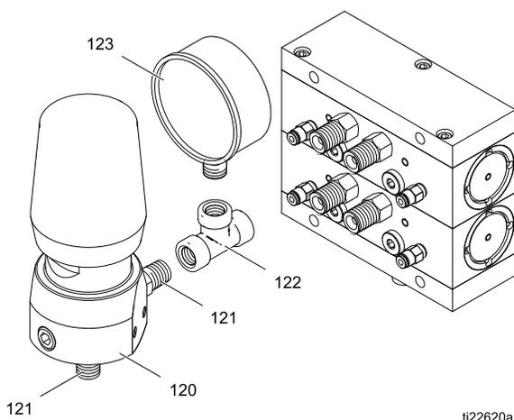
Figure 8 Установка регулятора обратного давления на клапане сброса в выпускном блоке
