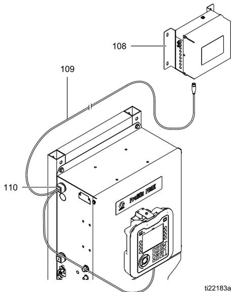
Figure 5 Кабельное соединение в электрическом блоке управления PD2K
