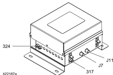
Figure 4 Кабельный разъем J7 в искробезопасном модуле управления цветом
