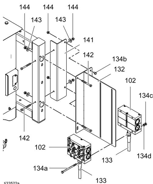
2. Установите монтажный кронштейн клапана (132) на PD2K и кронштейн для монтажа на выдвигной стойке (141), используя два комплекта винтов, шайб и гаек. Первый комплект, предназначенный для установки монтажного кронштейна клапана (132) на PD2K, включает два винта (142), шайбы (143) и гайки (144). Второй комплект, предназначенный для крепления монтажного кронштейна клапана (132) к кронштейну выдвигной стойки (141), включает два винта (134b) и шайбы (144).
