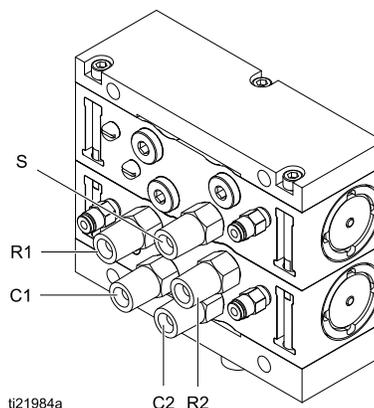
Figure 11 Соединения коллектора клапана (циркуляционная система)
