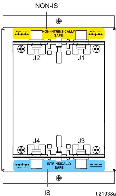
Figure 6 Подробная схема кабельных соединений изоляционной платы
