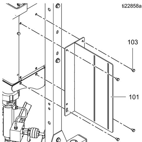
2. Установите коллекторы впускного и выпускного клапанов (102) на монтажный кронштейн (101), закрепив их четырьмя винтами (104), шайбами (105) и гайками (106).
