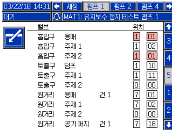
Figure 60 펌프 화면, 중복 밸브 할당
