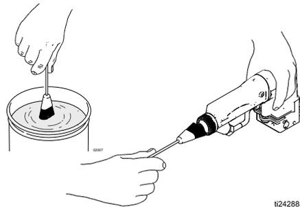
FIG. 13. Pulizia della parte anteriore della pistola
