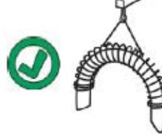
No comprima, estruje ni sujete la manguera con abrazaderas o bridas.
