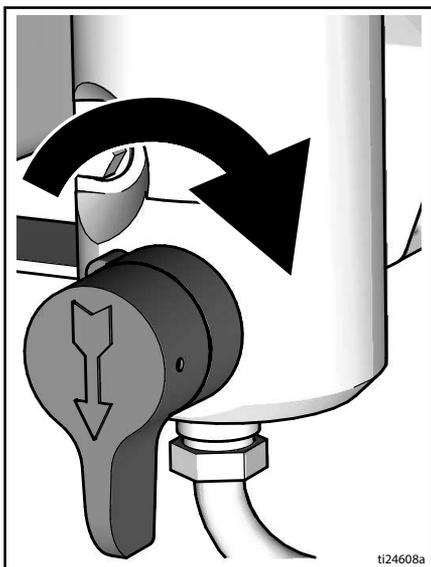
11. Sací hrdlo kapaliny s vypouštěcí hadicí zasuňte do uzemněné kovové nádoby částečně naplněné proplachovacím roztokem. Viz **Uzemnění**, strana 11.
