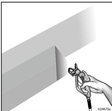
4. Po započetí pohybu stiskněte spoušť pistole. Před zastavením pohybu uvolněte spoušť pistole. Další informace o postupu stříkání naleznete v samostatné příručce k pistoli.
