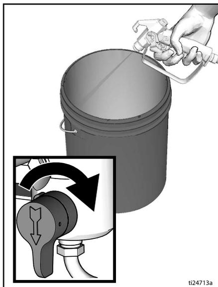
9. Vyměňte sací hrdlo nad proplachovací kapalinou.
