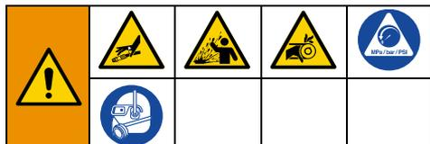
Zařízení zůstává pod tlakem, dokud nedojde k ručnímu uvolnění tlaku. Abyste pomohli zabránit těžkému zranění natlakovanou kapalinou, například vsířknutí pod kůži, výstřikem kapaliny a pohyblivých částí, postupujte podle pokynů uvedených v části Postup uvolnění tlaku, kdykoli přestanete stříkat a také před čištěním, kontrolou a údržbou zařízení.
