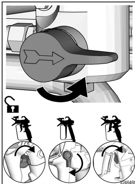
16. Podržte pevně kovovou část pistole směrem do uzemněné kovové nádoby. Spusťte pistoli a proplachujte ji, až bude čistá.
