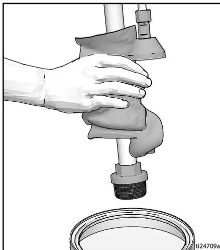
4. Vložte sací hrdlo do nádoby s proplachovací kapalinou. U vodou ředitelných barev použijte k čištění vodu, u olejových barev použijte lakový benzín. Vložte vypouštěcí trubkou do odpadní nádoby.
