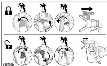
2. Zajistěte pojistku spouště. Vraťte stříkací trysku do původní polohy. Uvolněte ze záběru pojistku spouště a pokračujte ve stříkání.
