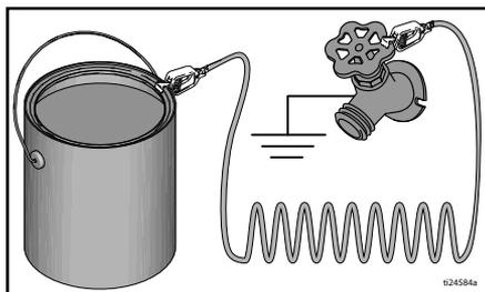
**Zajistěte vodivé spojení uzemnění při proplachování nebo uvolňování tlaku:** držte kovovou část stříkací pistole pevně u stěny uzemněné kovové nádoby. Až poté stiskněte spoušť.
