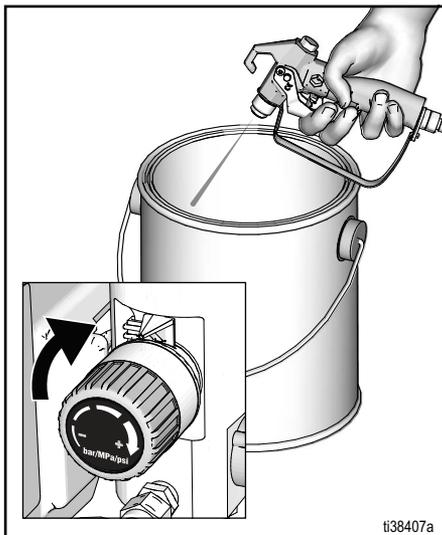
7. Uvolněte spoušť pistole. Přesuňte pistoli do nádoby na odpad, podržte pistoli u stěny nádoby a stisknutím spouště dostatečně propláchněte systém.
