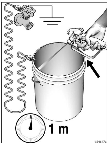
8. Přeneste pistoli do nádoby s barvou a na 20 sekund stiskněte spoušť a na 20 sekund stiskněte spoušť. Uvolněte spoušť a nechte ve stříkacím zařízení zvýšit tlak. Zajistěte pojistku spouště.
