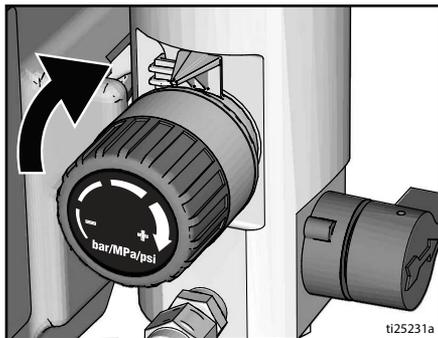
6. Otočte plnicí ventil do vodorovné polohy. Odjistěte pojistku spouště.
