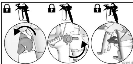
3. Nastavte otáčením regulátoru nejnižší tlak. Odjistěte pojistku spouště.
