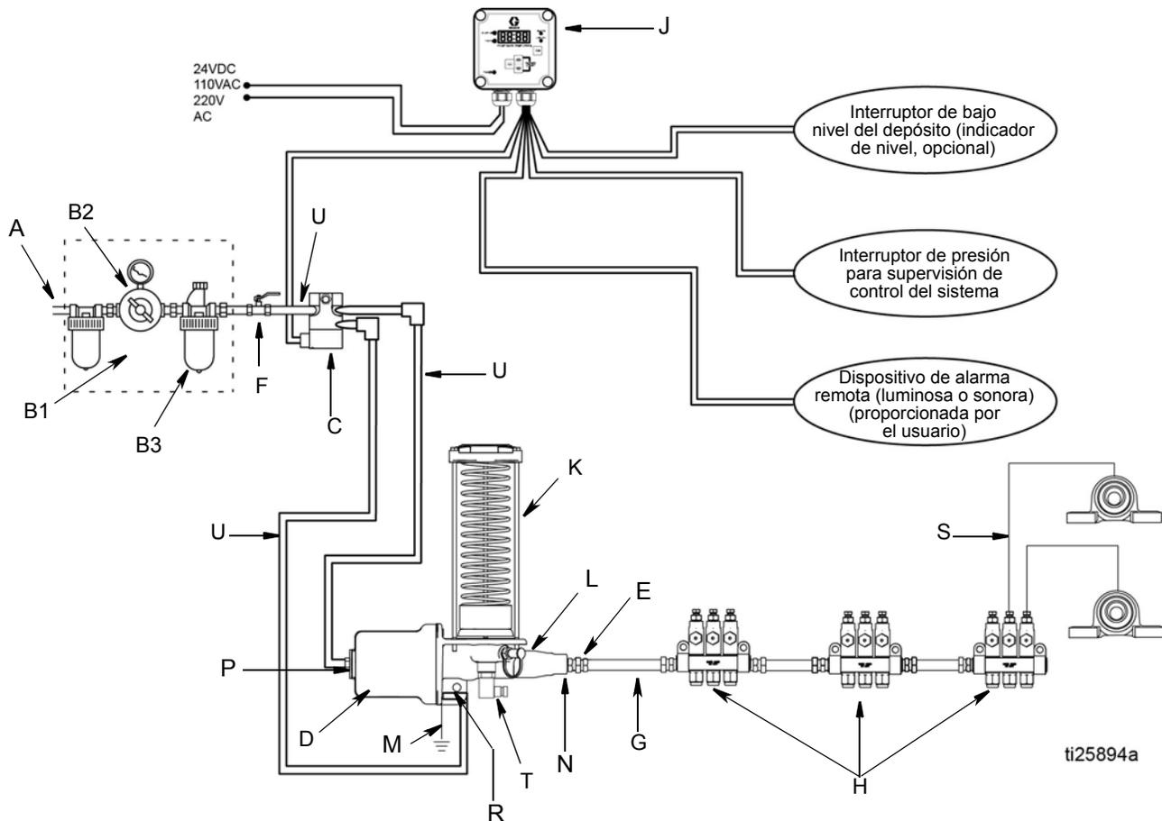
FIG. 1: Instalación típica
