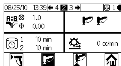
FIG. 16. Pulverización de mezcla en ejecución (pantalla 2)
