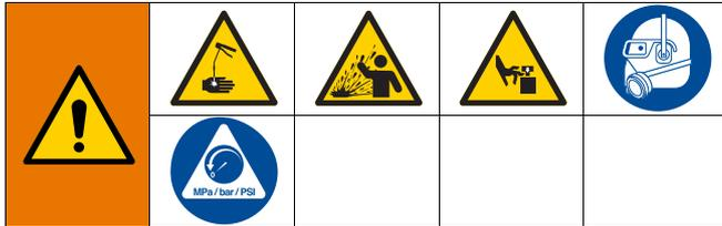
El equipo permanecerá presurizado hasta que se alivie la presión manualmente. Para evitar lesiones graves por fluido presurizado, como la inyección en la piel, salpicaduras de fluido y las ocasionadas por piezas en movimiento, siga el Procedimiento de liberación de presión cuando deje de pulverizar y antes de limpiar, revisar o dar servicio al equipo.
