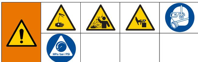
L'attrezzatura rimane pressurizzata fino a quando la pressione non viene scaricata manualmente. Per evitare gravi lesioni causate dal fluido pressurizzato, ad esempio iniezioni nella cute, da schizzi di fluido e da parti in movimento, seguire la procedura di rilascio pressione quando si smette di erogare e prima di pulire, verificare o eseguire la manutenzione dell'apparecchiatura.
