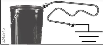
**Para mantener la continuidad de la conexión a tierra cuando se lava el pulverizador o se libera la presión:** mantenga la parte metálica de la pistola de pulverización firmemente contra el costado de un cubo metálico conectado a tierra y active la pistola.
