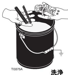
5. 洗淨用液体がある程度入っている接地済みのペール缶にサイフォンチューブを入れます。接地線を接地します。始動手順 10 - 17 (13ページを参照) を実施してスプレーヤ内の塗料の洗淨を行います。水を使用して水性塗料の洗淨を行い、ミネラルスピリット溶剤（ホワイトスピリットとも言う）を使用して油性ペンキの洗淨を行います。
