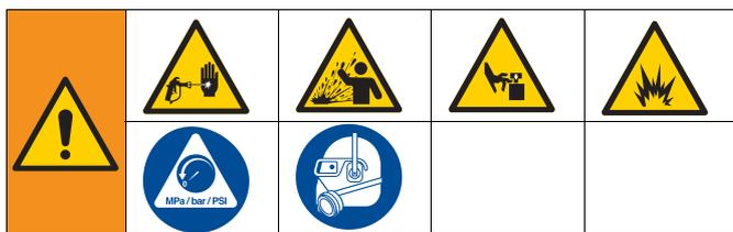
本装置は、圧力が手動で開放されるまでは、加圧状態が続きます。皮膚の貫通などの加圧状態の液体、液体の飛散、および可動部品から生じる重大な怪我を避けるには、スプレー停止後と装置を清掃、チェック、および点検する前に、圧力開放手順に従ってください。
