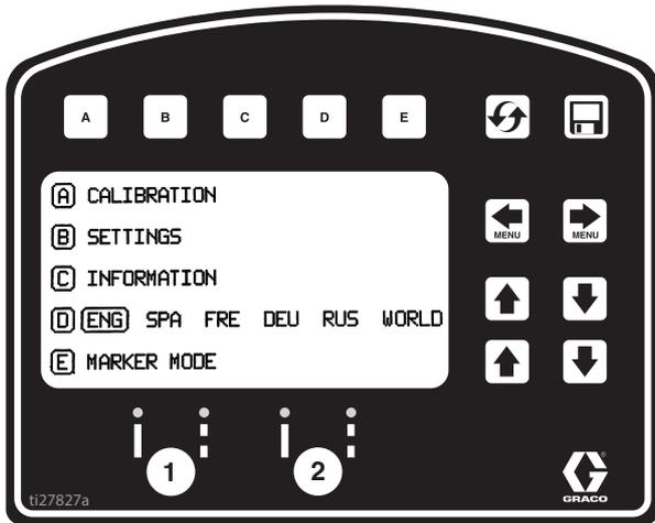
4. 較正するには **A** を押します。[TRAVEL DIST] を 7.6 m (25 フィート) に設定します。条件によって、距離が長いほど精度が高くなります。
