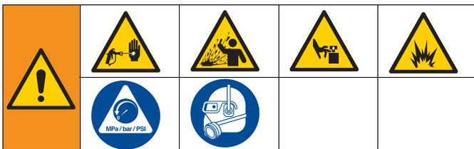
Este equipo seguirá presurizado hasta que se alivie manualmente la presión. Para ayudar a evitar lesiones graves por fluido presurizado, como la inyección en la piel, salpicaduras de fluido y las ocasionadas por piezas en movimiento, siga el Procedimiento de descompresión cuando deje de pulverizar y antes de limpiar, revisar o dar servicio al equipo.
