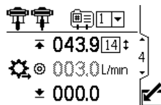
Figure 13 运行屏幕 4，处于压力模式
