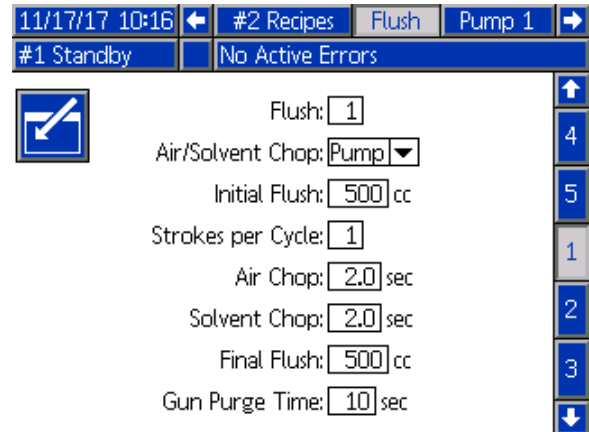
Figure 55 Schermata di lavaggio con interruzione aria/solvente
