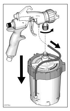
2. 拧松喷壶上的座圈。取下喷壶上的护盖 和座圈。确保在取下护盖和座圈时 FlexLiner 仍留在喷壶中。
