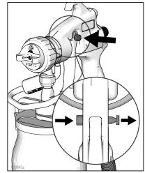
8. 当 HVLP 喷涂机电源为 ON(打开)时, 请将喷枪指向废品区。垂直握枪并扣动 扳机,直到观察到喷涂机已经进入连续 喷涂模式为止,确保空气都从 FlexLiner 系统中排出。
