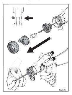
3. 将扳机滑块从喷涂位置(A)移到枪针拆卸位置(B)。
