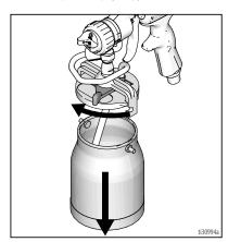
3. 打开并从虹吸式喷壶上取下喷壶盖。 将多余的涂料放回至原始容器。
