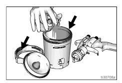
4. 安装喷壶上的护盖和座圈。牢牢紧固 接头。
