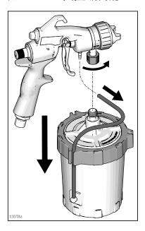
3. 拧松喷壶(5)上的座圈(1)。从喷壶上取下座圈(1)以及护盖(2)。确保在取下护盖和座圈时 FlexLiner(4)仍留在喷壶中。
