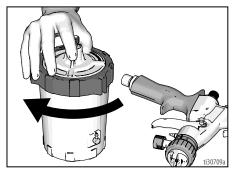
5. 将 FlexLiner 系统与喷枪连接。
