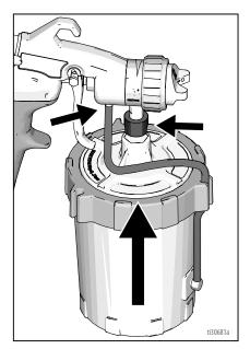
6. 将喷枪空气软管与入口管件连接。
