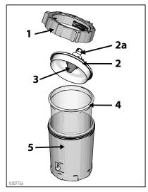
4. 将多余的涂料放回至原始容器。倾注时将 FlexLiner (4) 固定在适当的位置上。
