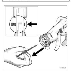
擦拭或冲洗掉喷嘴和枪针上的液体。如 有必要,请清洗固定环、空气帽、空气帽导轨以及弹簧。
