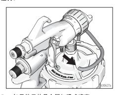
如果使用的是金属虹吸式喷壶: 拉开喷壶盖,从盖上拧松或取下喷壶进行 泄压。
