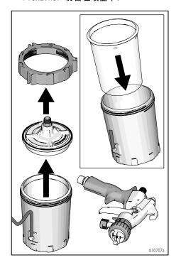
3. 用材料填满 FlexLiner 直到 "最大容量"线。清理 FlexLiner 系统的螺纹和密封圈表面。
