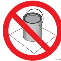
**Siempre ponga a tierra un cubo de metal:** conecte un cable de puesta a tierra al cubo. Conecte un extremo al bidón y el otro a una puesta a tierra verdadera, como una tubería de agua.
