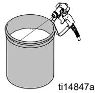
9. Suba el tubo de aspiración por encima del fluido de lavado y haga funcionar el pulverizador durante 15 a 30 segundos para drenar el fluido. Apague el interruptor de la bomba y el motor
