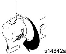
11. Retire los filtros de la pistola y pulverizador, si están instalados. Limpie e inspeccione. Instale los filtros.
