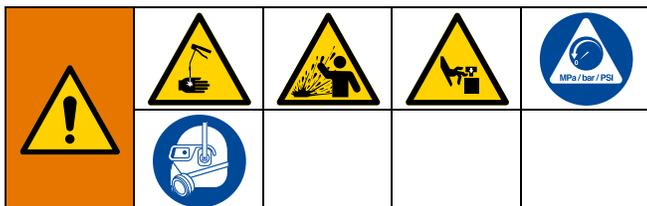
Cet équipement reste sous pression tant que la pression n'a pas été relâchée manuellement. Pour prévenir de graves blessures provoquées par du liquide sous pression, comme des injections cutanées, des éclaboussures et des pièces en mouvement, suivez la Procédure de décompression une fois la pulvérisation terminée et avant un nettoyage, une vérification ou un entretien de l'équipement.
