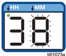
Esto confirma que se está configurando el segundo dígito del TIEMPO OFF para las horas (HH).
