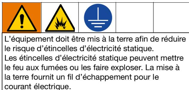
Raccordement de la pompe à la terre : Retirez la vis de mise à la terre (Z) située au dos du boîtier de vitesses et insérez-la dans l'œillet de la cosse à anneau (W) à l'extrémité du fil de terre (Y). Revissez la vis de mise à la terre (Z) sur la pompe et serrez-la bien. Raccordez l'autre extrémité du fil de terre (Y) à une vraie terre (FIG. 1). Pour commander un fil de terre et un serre-câble, indiquez la référence 222011.
