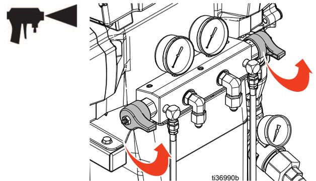
6. Maintenez le collecteur de fluide de pistolet au-dessus de deux conteneurs à déchets mis à la terre. Ouvrez les vannes de fluide XA et XB (voir **Identification des composants** page 17) jusqu'à ce que seul du solvant s'écoule des vannes. Fermez les vannes. Le flexible et le collecteur de pistolet du Reactor sont maintenant rincés.
