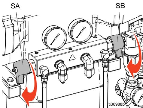
4. Utiliser le mode Jog pour faire circuler le fluide. Les systèmes Reactor permettent à l'ensemble du système d'être en mode Jog, et aux pompes de transfert côtés A et B d'être mises en mode Jog séparément. Voir **Mode Jog (à-coups)**, page 31. Faites circuler le fluide jusqu'à ce que seul le solvant sorte des vannes de décompression. Le rinçage des tuyaux d'alimentation, pompes et réchauffeurs du Reactor est terminé.
