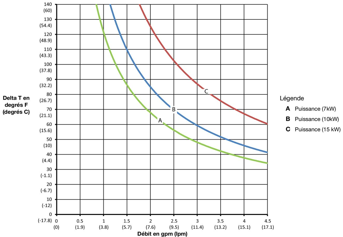
**REMARQUE :** Les données de rendement du réchauffeur sont basées sur des essais avec de l'huile hydraulique de poids 20 W et avec 240 V passant par les fils d'alimentation électrique du réchauffeur.
