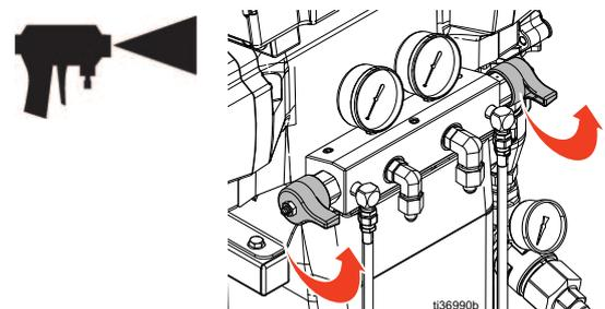
12. Engagez le verrouillage de sécurité du pistolet, puis fermez les vannes A et B du collecteur de fluide.
