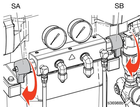
12. Vérifiez si un bruit de crachotement provient des vannes de décompression (N) ou des lignes de recirculation (R). Voir **Installation type**, page 14. Ce bruit indique que le système Reactor contient encore de l'air. Si le système contient encore de l'air, répétez la procédure de purge d'air.
