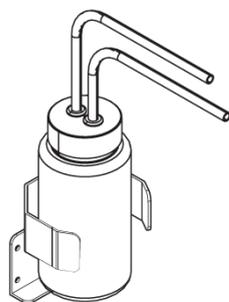
4. Utilisez les jauges de niveau de fût (24M174) A et B pour mesurer le produit dans chaque fût. Si nécessaire, le niveau peut être saisi et suivi avec l'ADM.
