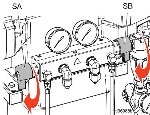
12. Ouvrez les vannes de fluide du pistolet des côtés A et B.
