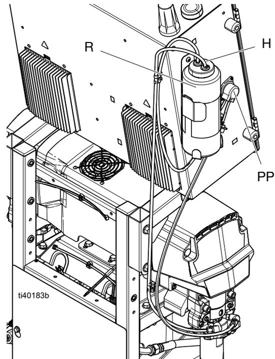
7. Vérifiez que la pompe de fluide TSL fonctionne correctement en sentant les pulsations dans le flexible de retour pendant le fonctionnement normal de la pompe du doseur.
