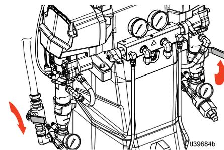
11. Réglez les vannes de décompression/pulvérisation (SA, SB) sur pulvérisation pour contenir l'humidité de la conduite de vidange.
