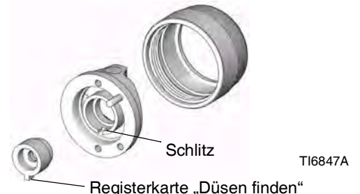
ABB. 7: Einrichten von Spritzdüse und Luftkappe
