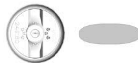
Fig. 8: Posizioni del ventaglio di spruzzatura
