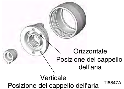
FIG. 11: Posizioni del perno di allineamento del cappello dell'aria
